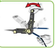
Es müssen mindestens 1,5 Umdrehungen auf der Welle aufgerollt sein. Maximal 2 Umdrehungen bei X-Light und maximal 3 Umdrehungen bei Passion / Pro dürfen aufgerollt werden. Je nach gewünschter Dehnung kannst du die Spannung variieren.
