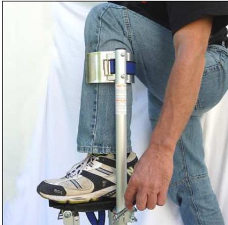
(7) Stellen Sie Ihr Bein auf die Stelze, um die Position der Beinhalterung anzupassen. Wählen Sie die Höhe so, dass der Gurt der Beinhalterung (H4) sich knapp über der dicksten Stelle Ihrer Wade befindet und ziehen Sie die Schrauben an der Klammer (H29 / H30) an.
