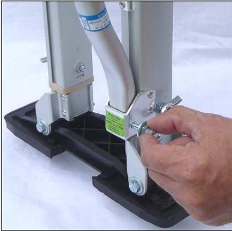
(5) Verbinden Sie das Rohr mit der Schraube und der Stopfmutter (H24 - H13A) an dem Träger. Ziehen Sie diese Schraube erst nach Fertigstellung der Montage endgültig fest.
