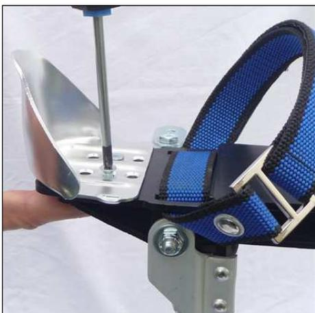
(1) Die sechs Löcher in der Fersenhalterung (H10), die auf der Fußplatte (H9) befestigt wird, dienen der Anpassung an die Schuhgröße. Schrauben Sie die Fersenhalterung an die Fußplatte.
